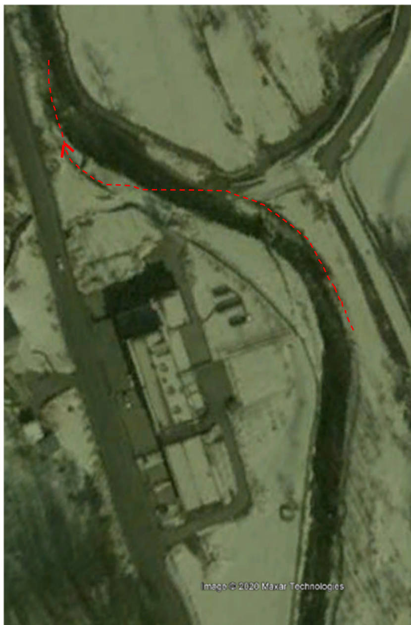
Figura 2-2– Torrente Mongia in territorio di Lisio – La corrente sale dal basso verso l’alto della foto. Visione invernale (marzo 2003) dell’ansa che può spiegare la pressione contro la sponda destra e, in uscita, l’erosione attualmente riscontrabile nella sponda sinistra.
